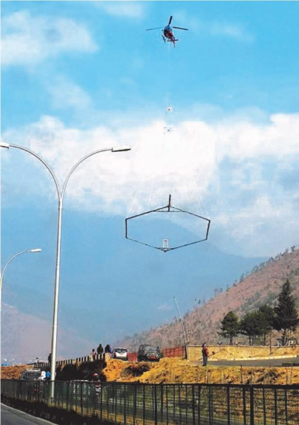
**Start vom Helipad in Thimphu: Ein Helikopter trägt einen hexagonalen Metallring, der elektromagnetische Wellen aussendet.**
